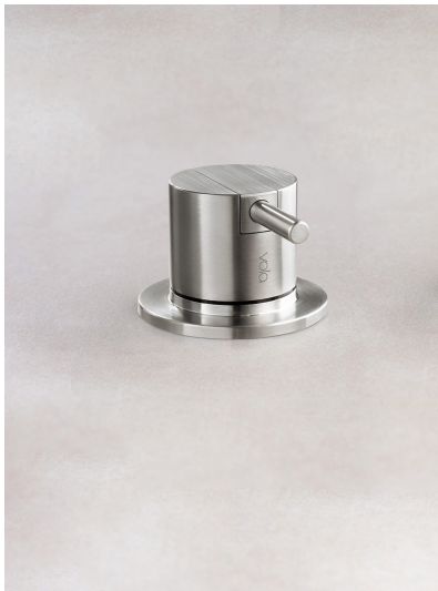
2500 Eingriffmischer für Tischmontage Edelstahlmantel-Anschlusschläuche 10 mm. Lochbohrung 42 mm für größere Durchflussleistung wie z.B. Wannenbefüllung.
