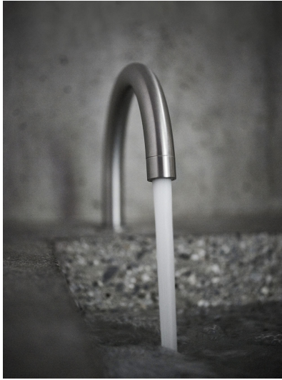
090E Schwenkauslauf für Wannenrandarmatur ¾", Höhe 170 mm, Rohrdurchmesser 24 mm, maximale Einbaustärke 50 mm, Montage nicht in Verbindung mit Muffe 200M, Rosette Durchmesser 40 mm. Lochbohrung 22 mm.
